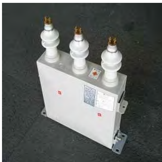
過電流により膨らんだ高圧コンデンサの一例
